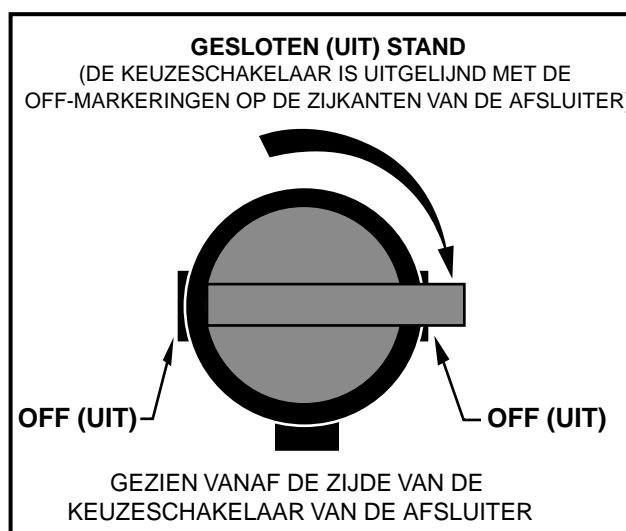
Figuur 12 Gesloten brandstofafsluiter
