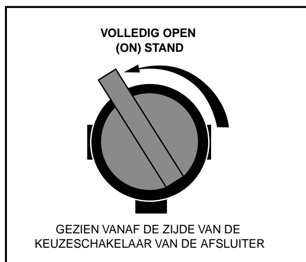
Figuur 13 Open brandstofafsluiter
