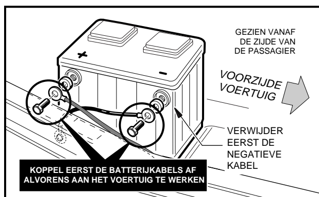
Figuur 1 Verwijderen van de batterijkabel
