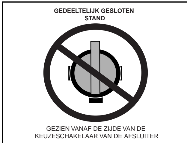
Figuur 14 Gedeeltelijk gesloten brandstofafsluiter
