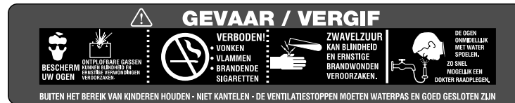
GEVARENSTICKER BATTERIJ (OP CARROSSERIE, ONDER BANK)
