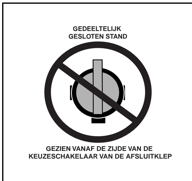
Figuur 14 Brandstofafsluitklep – gedeeltelijk gesloten stand
