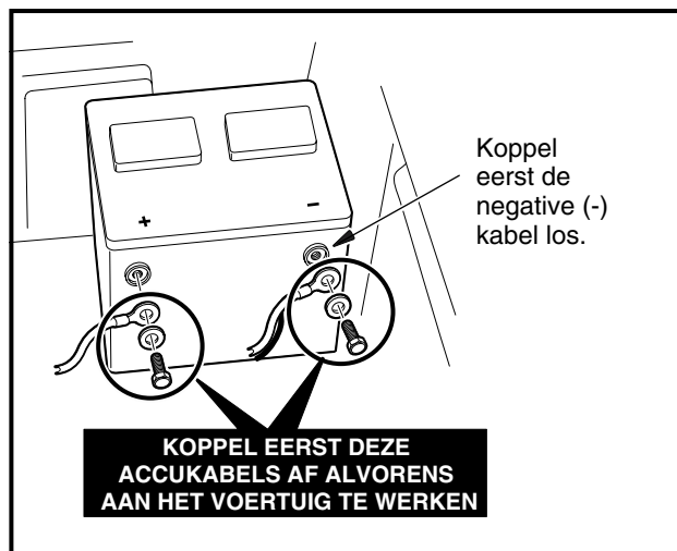
Figuur 2 Ontkoppelen accukabel – benzine
