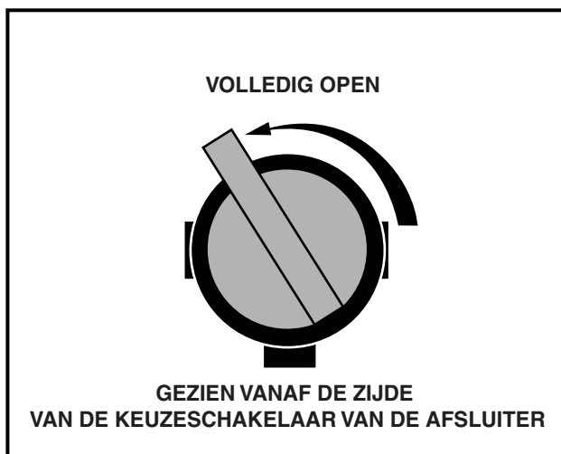
Figuur 21 Brandstofafsluiter – open stand
