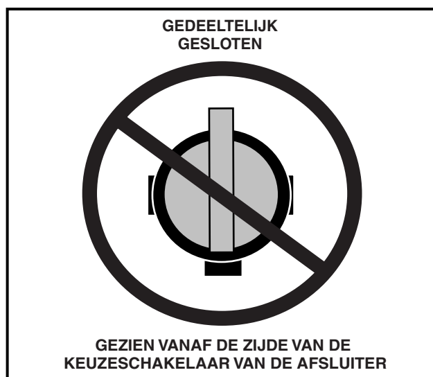
Figuur 18 Verkeerde afstelling van de brandstofafsluiter
