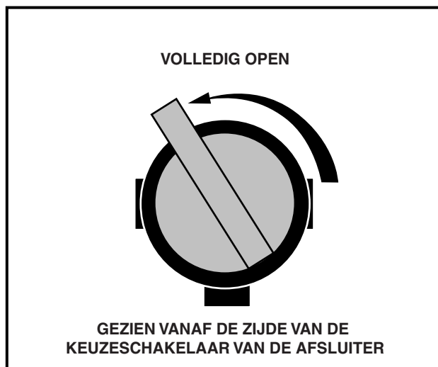
Figuur 17 Brandstofafsluiter – open
