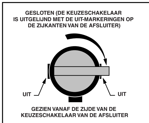
Figuur 16 Brandstofafsluiter – gesloten
