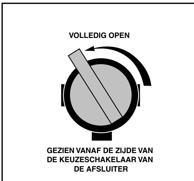
Figuur 11 Brandstofafsluiter – open
