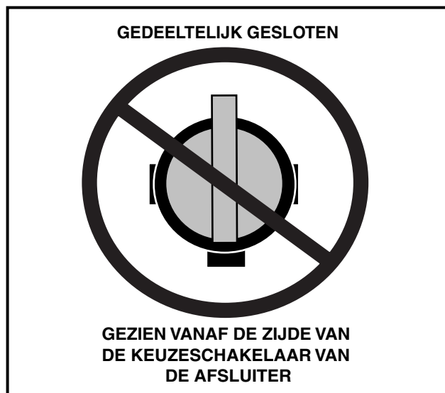
Figuur 12 Verkeerde afstelling van de brandstofafsluiter
