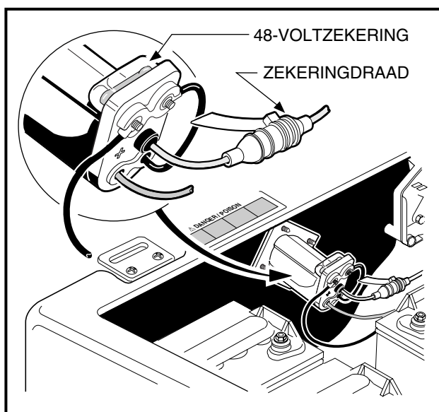
Figuur 16 Zekering stopcontact voor 48-volt voertuig
