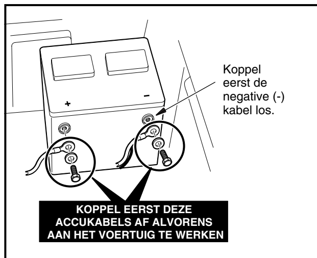
Figuur 2 Ontkoppelen accukabel – benzine
