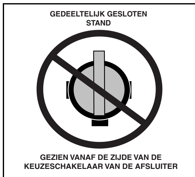
Figuur 16 Verkeerde afstelling van de brandstofafsluiter
