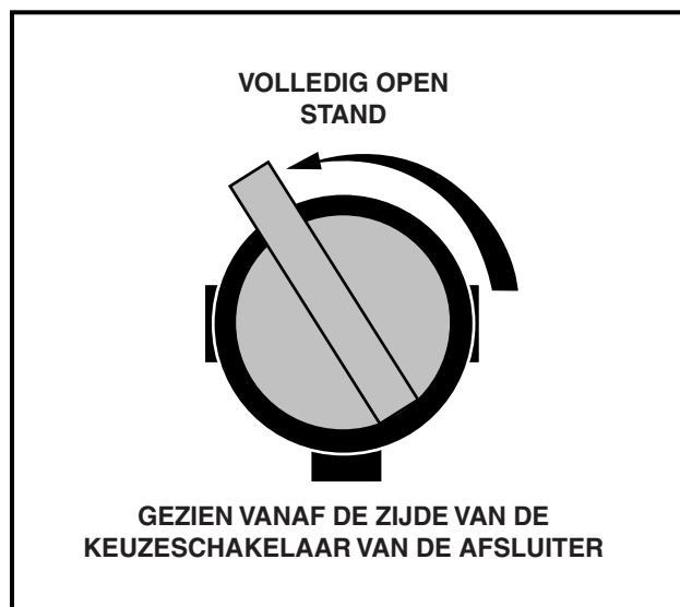
Figuur 15 Brandstofafsluiter – open stand
